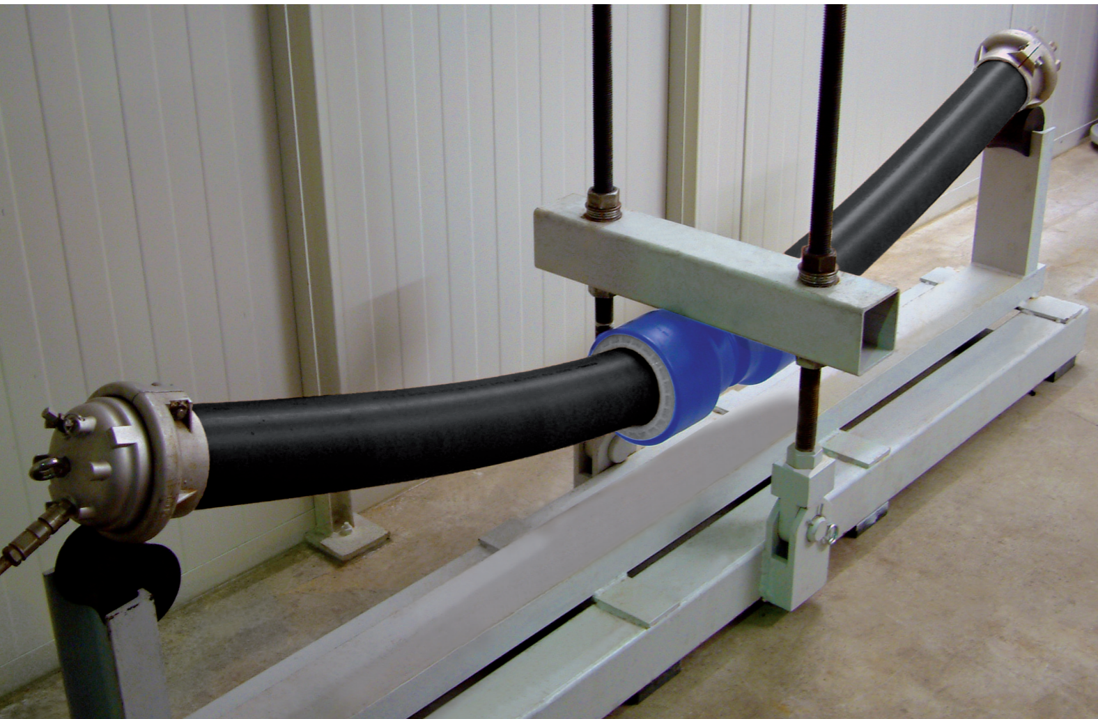
Buig test met interne test druk van 30,4 bar
